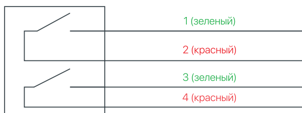
Рисунок 2. Схема подключения сигнализатора давления.
